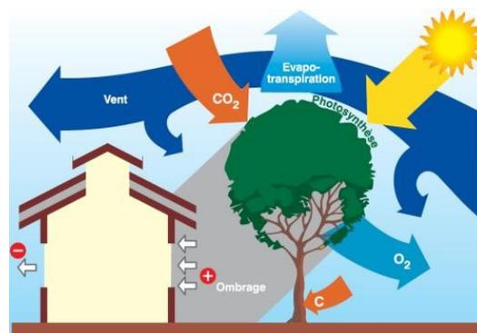
Une bande d'au moins 3 mètres de large de végétalisation au sol ou d'écrans solaires sur les 2/3 de la périphérie du bâtiment est une protection efficace à l'ensoleillement direct (source : label ECODOM).
