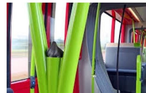
*Exemple de bouchon de barres du tramway
