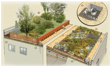
Toiture végétalisée intensive et extensive Source : CG 92
